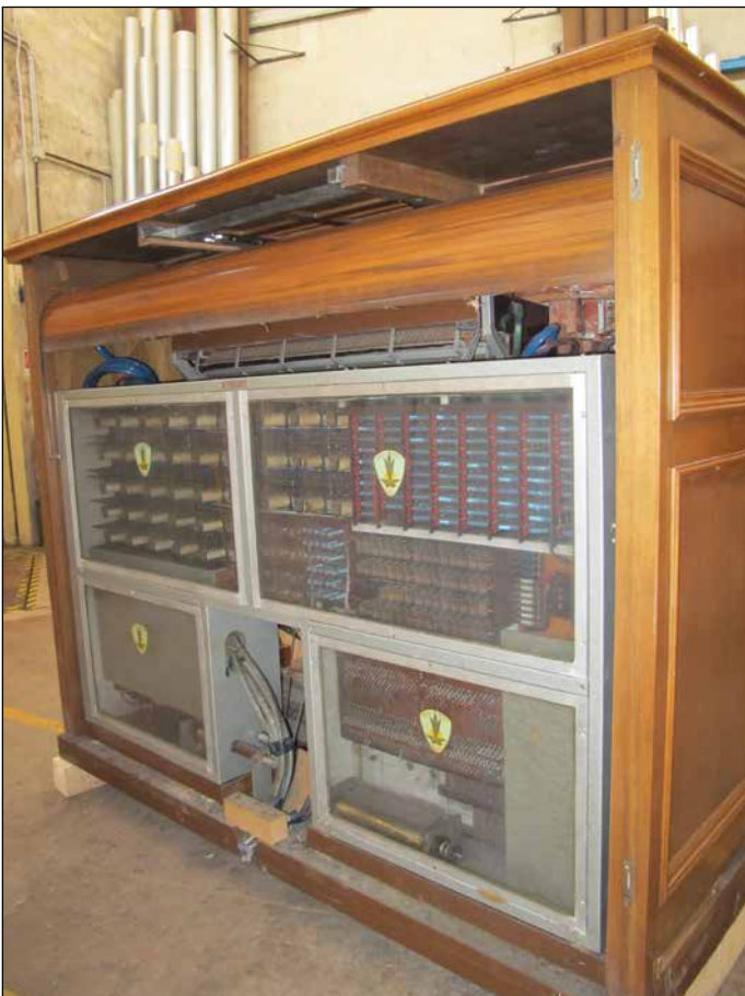
I meccanismi originali interni della consolle, tutti costruiti in casa e sigillati sotto vetro
