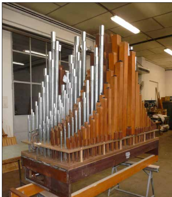
A destra: prova di un somiere dello Swell in laboratorio
