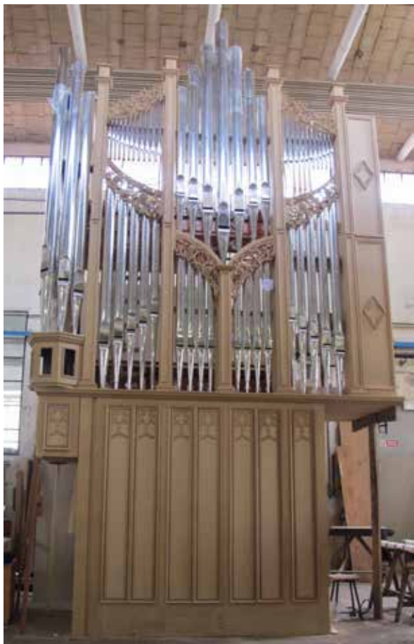
Una delle casse in rovere in fase di assemblaggio in laboratorio
