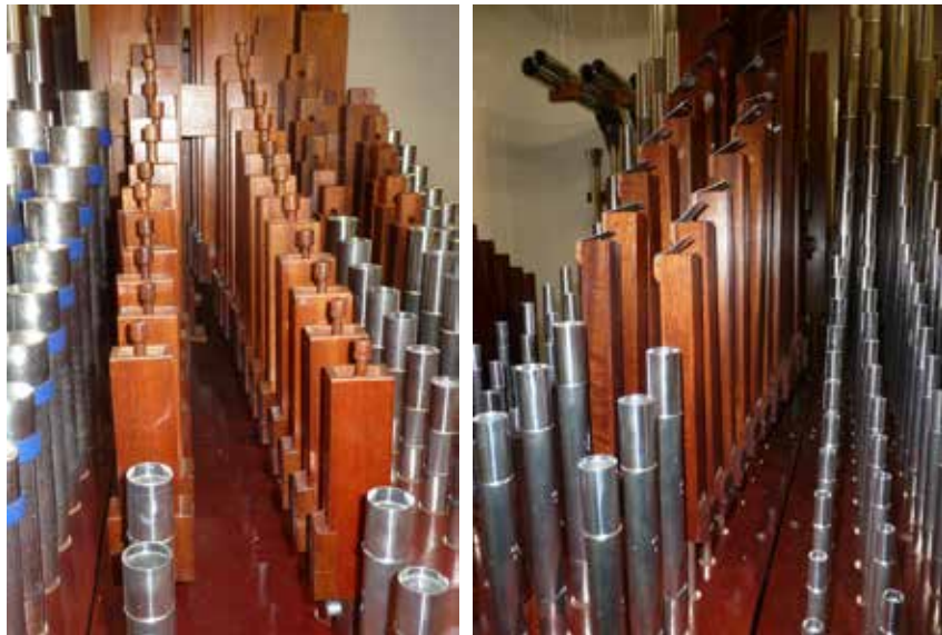
Canne del Solo. A Sinistra: il Doppelflöte 8' con le sue canne in legno a doppia bocca. A destra: l'Orchestral Flute 8', con canne armoniche (a doppia altezza), pure in legno.
