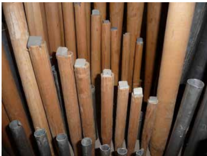
Un particolare di canne interne. L'accordatura è fatta spostando le piccole "calate" metalliche inserite alla sommità dei risuonatori. Permettono di regolare la lunghezza delle canne per ottenere un'accordatura precisa.
